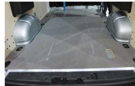
Anordnung der Verzurrösen im Kastenwagen mit Radstand mittellang.
