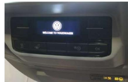
Steuergerät für Zusatzheizung.
