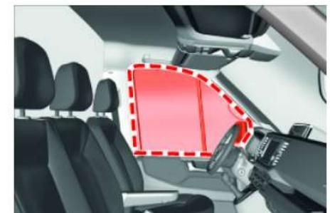
Schematische Darstellung des geöffneten Kopfairbags.
