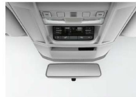
Bedienteil in der Dachkonsole über dem Rückspiegel.
