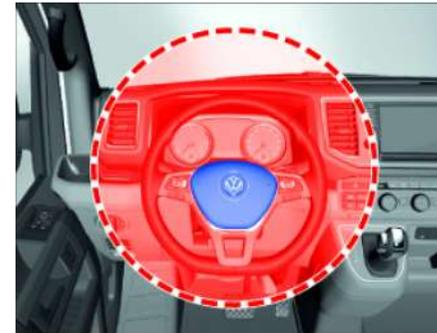
Schematische Darstellung des geöffneten Airbags auf der Fahrerseite.
