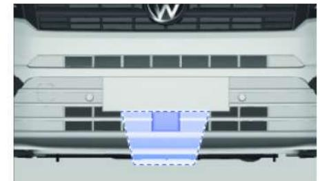
Platzierung des Radarsensors im Kühlergrill.
