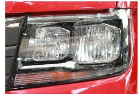
Tagfahrlicht in Halogen-Doppelscheinwerfer, LED-Leuchtmittel rechts oben.
