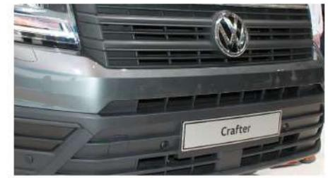
Beispiel der Ultraschallsensoren im Stoßfänger.
