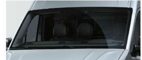
Verbundglas-Frontscheibe in Wärmeschutzverglasung.
