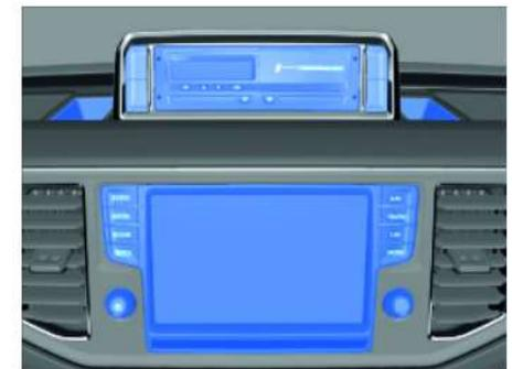
Einbauort des digitalen Tachografes in der 1-DIN Aufsatzkonsole.
