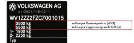
Typenschild mit erforderlichem bzw. maximalem zulässigem Zuggesamtgewicht (zZGG).
