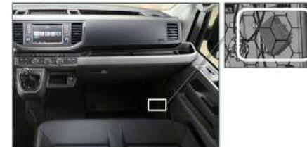
Einbaulage elektrische Klemmleiste.
