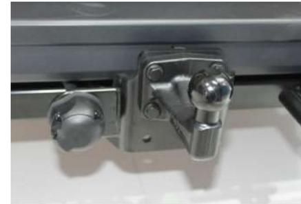
Anhängevorrichtung mit Kugelkopf.
