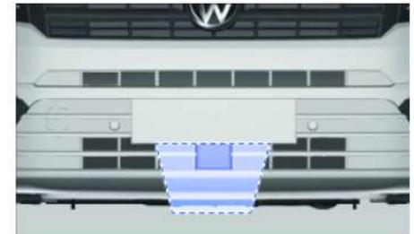
Einbauort des Radarsensors.
