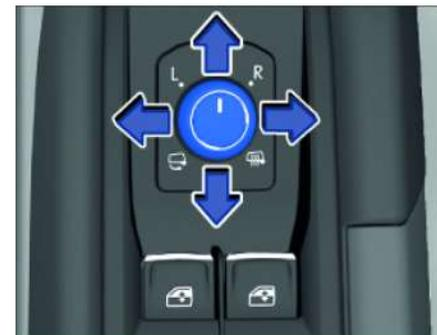
Schematische Darstellung des Spiegelverstellungsschalters.
