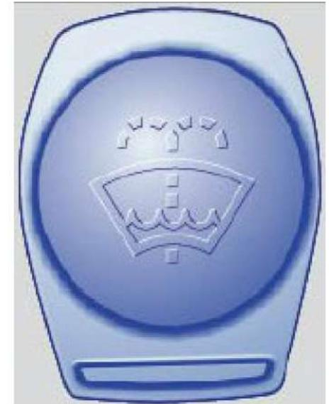
Abbildung des Deckels des Scheibenwaschwasserbehälters.
