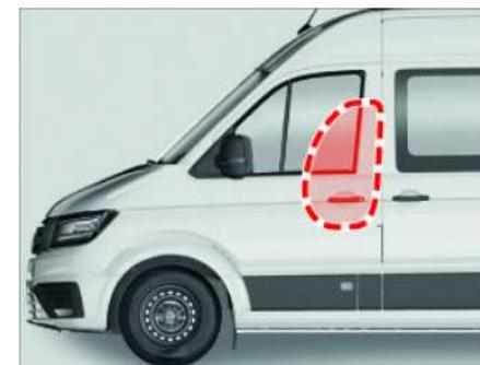
Schematische Darstellung des geöffneten Seitenairbags.
