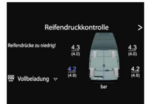
Beispielhafte Darstellung eines fehlerhaften Solldruckes.
