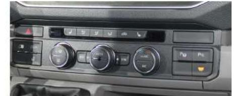
Regelinheit für die Klimaanlage "Climatronic".
