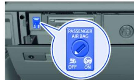
Schlüsselschalter zur Aktivierung /Deaktivierung des Beifahrer-Airbags.
