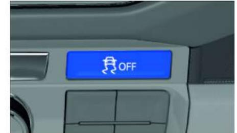
ESP-Aus-Schalter (bei Heckantrieb und 4MOTION).
