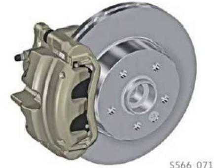
Schema der Scheibenbremse vorn.
