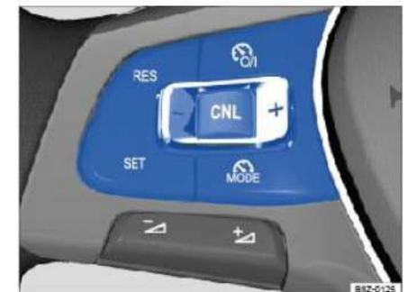
Abb. 98 Linke Seite des Multifunktionslenkrads: Tasten zum Bedienen des Geschwindigkeitsbegrenzers.
