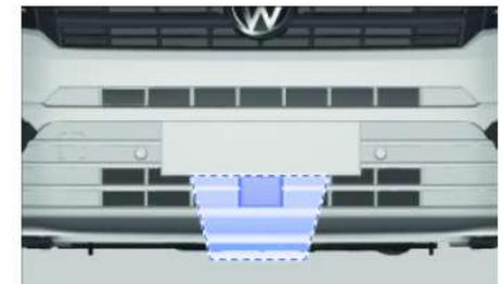
Einbauort des Radarsensors.
