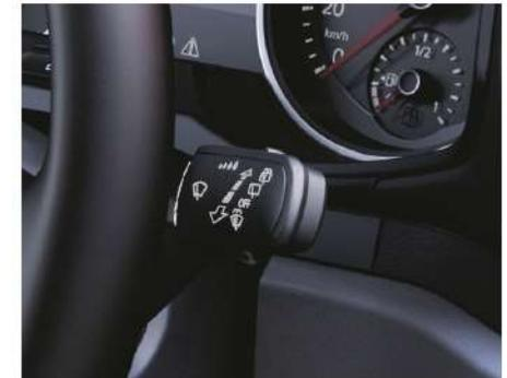
Scheibenwischerhebel an der rechten Seite des Lenkrades mit diversen Einstellmöglichkeiten (z. B. Intervallwischen).
