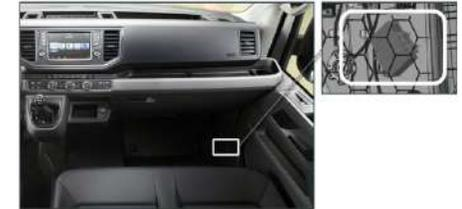
Einbaulage elektrische Klemmleiste.
