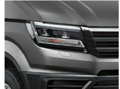
Scheinwerfer-Reinigungsanlage im Stoßfänger integriert.
