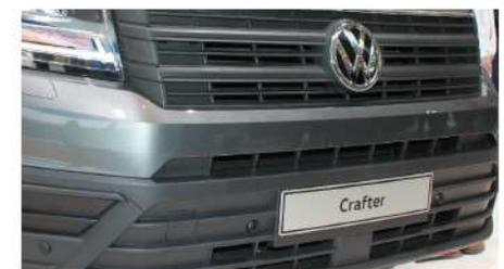
Beispiel der Ultraschallsensoren im Stoßfänger.
