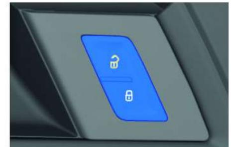
Verriegelungstaster in der Türverkleidung auf der Fahrerseite.
