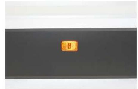
Seitliche Markierungsleuchte in der Seitenschutzleiste integriert.
