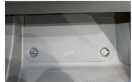
Gummibodenbelag mit Abdeckung für das Bordwerkzeug auf der Beifahrerseite.
