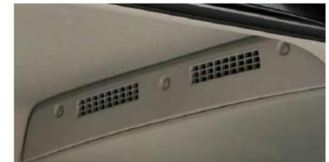
Luftausströmer unter dem Dachhimmel in Höhe der B-Säulen.
