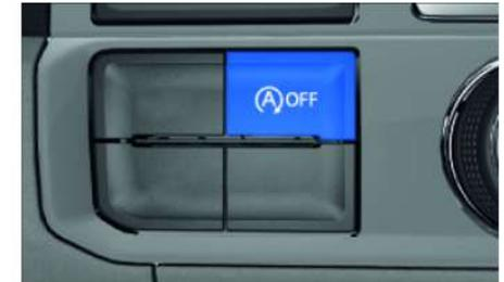
Schalter in der Instrumententafel zum aktivieren/deaktivieren des Motor-Start-Stopp-Systems.
