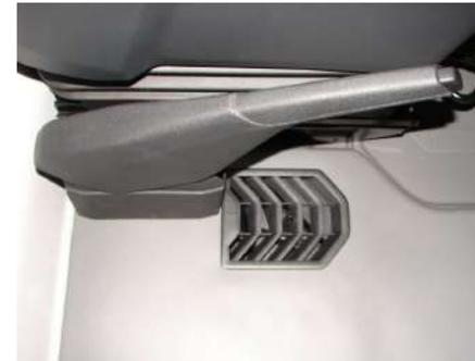
Luftausströmer unter dem Handbremshebel im Fahrerhaus.
